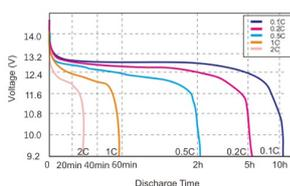
TEMPERATURE DISCHARGE CHARACTERISTICS 25°C
